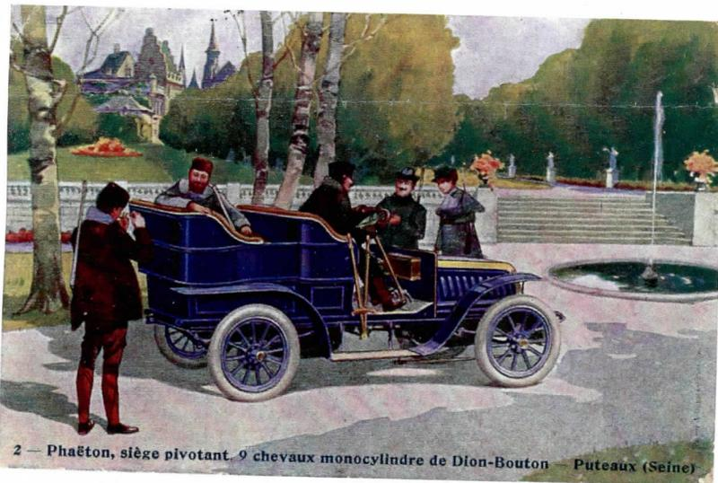
2 — Phaëton, siège pivotant. 9 chevaux monocylindre de Dion-Bouton — Puteaux (Seine)
